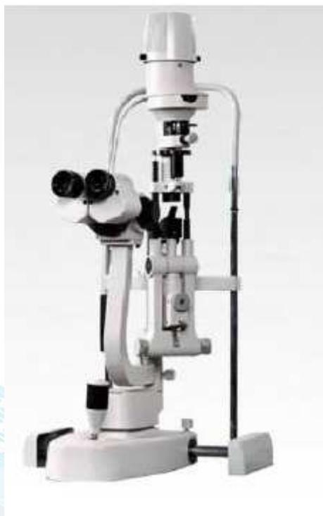
Ce microscope professionnel à optiques convergentes, de type galiléen classique Haag-Streit est distribué par socimed. Il est équipé d'un grossissement optique à 3 paliers et à tambour rotatif ; d'une ouverture de 14 mm aidant à observer la cornée et l'iris entier, ainsi que tout autre objet, il offre une image bien définie, son interface est compatible avec laser et tonomètre à aplanation
